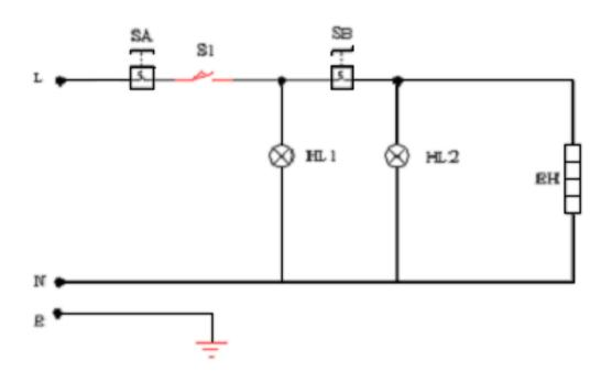
S1 — MICRO-SWITCH TEMPERATURE CONTROLLER HL1—POWER INDICATOR E—EARTH OF CASE SA — HEAT BREAKER SB —
